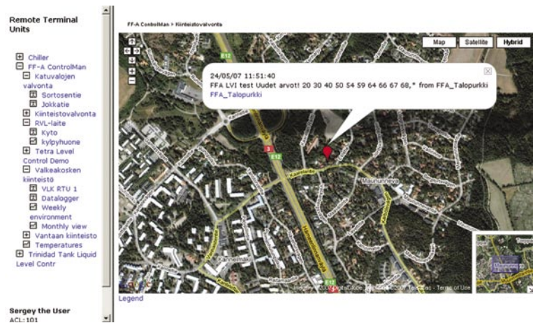
Рис. 3. Пример использование системой GSM Control карты Google Maps для представления информации
